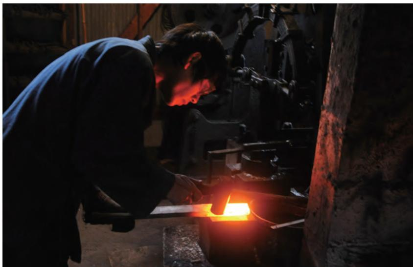
地鉄を鍛造して所定の厚みと幅にする。(敷作り)
